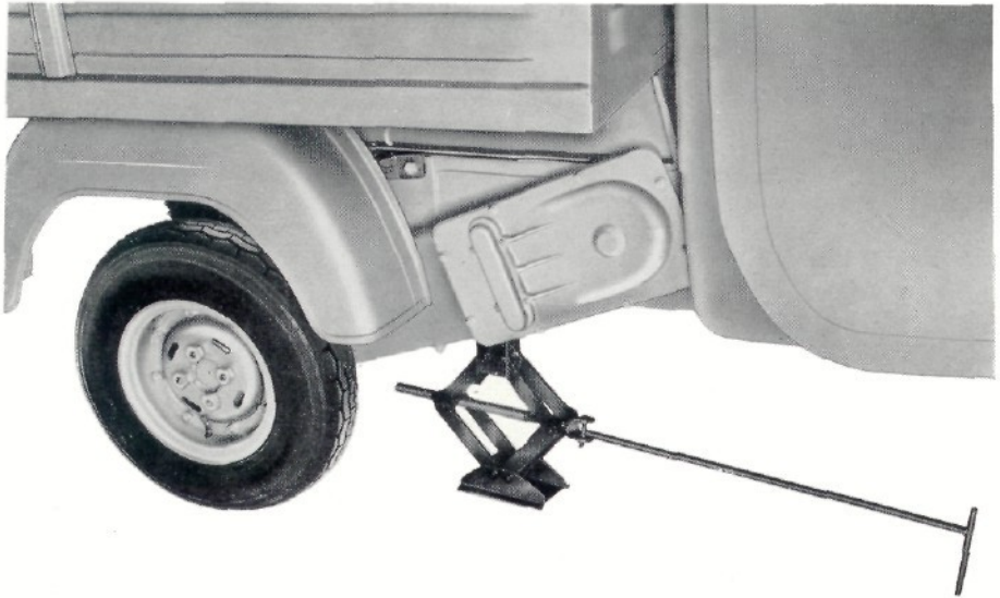
Fig. 15 - Applicazione martinetto di sollevamento - Smontaggio ruota.
